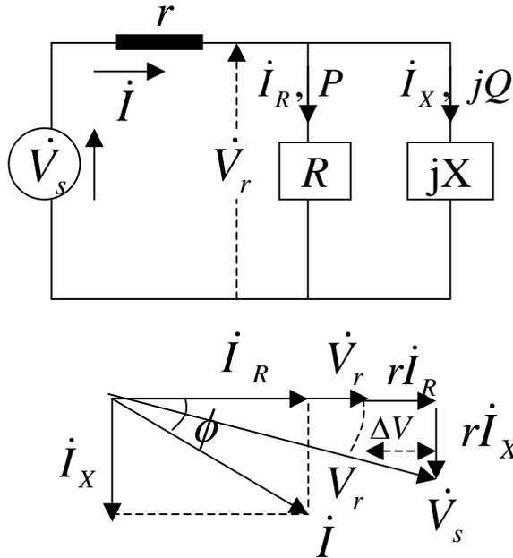
上図のように、線路インピーダンスとして、抵抗  $r$  だけが含まれる場合、線路電圧降下  $\Delta V$  はリアクタンス分電流による電圧降下  $rI_X$  が電圧にほぼ直角であるため、電圧降下に寄与せず、電圧降下は、ほぼ、 $rI_R$  すなわち、電流の有効電力対応分と線路抵抗の積のみによって決まることとなります。
