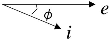
図のように、電流位相が電圧より  $\phi$  だけ遅れている場合を考えます。
