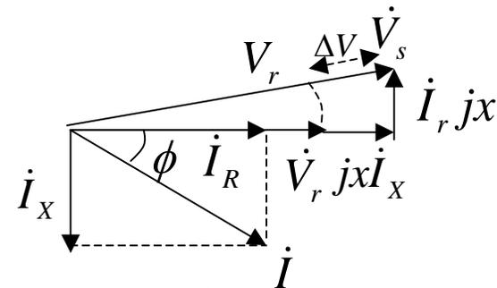
上図のように、線路インピーダンスとして、リアクタンス  $x$  だけが含まれる場合、線路電圧降下  $\Delta V$  は抵抗分電流による電圧降下  $\dot{I}_R$   $jx$  が電圧にほぼ直角であるため、電圧降下に寄与せず、電圧降下は、ほぼ、 $I_X jx$  すなわち、電流の無効電力対応分とリアクタンスの積のみによって決まることになります。
