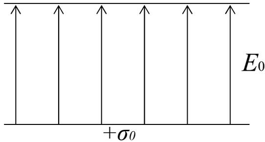
図 a のように、面電荷密度  $\sigma$  を蓄えた空気絶縁平行板コンデンサがある。
